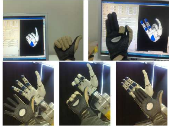
Fig. 10. Teleoperación mediante la correspondencia articulación a articulación descrita en la Sección IV, usando el módulo de simulación de la mano (fila superior) y usando la mano real (fila inferior).
